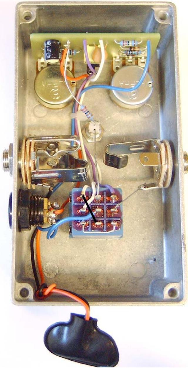
Bei ordnungsgemäßem Aufbau sollte das Gerät auf Anrieb funktionieren. Die meisten Fehler werden erfahrungsgemäss bei der Verdrahtung gemacht. (Inputbuchse → Tip und Ring vertauscht) sowie schlechte Lötstellen und Zinnbrücken auf der Leiterplatte. Hier sollte man sich etwas Zeit nehmen, um sich eine etwaige Fehlersuche hinterher zu ersparen.
